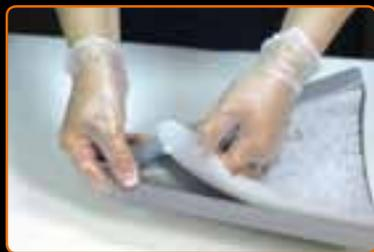
**1** Con un panno bagnato inumidire leggermente la superficie del supporto in plastica. Inserire il guscio in silicone all'interno del termoformato facendo corrispondere bene gli appositi fermi in silicone con i fori del sostegno.
