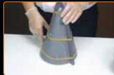
**4** Unire i due termoformati facendo attenzione che i piccoli incastrì sui lati del guscio in silicone combacino perfettamente e fissare applicando gli appositi elastici in dotazione con il kit termoformato.
